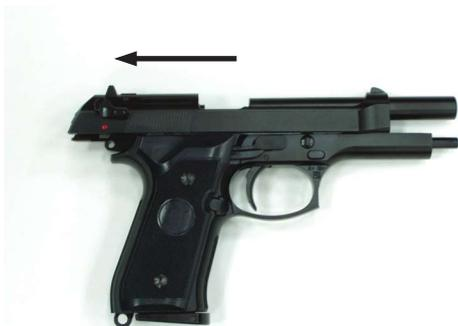
PULL THE SLIDE COMPLETELY TO THE REAR.
